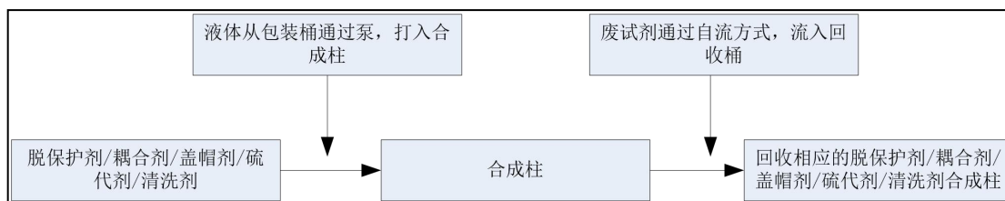
图 4.7.1-2 脱保护、耦合、盖帽、硫代工序物料转移方式说明图
